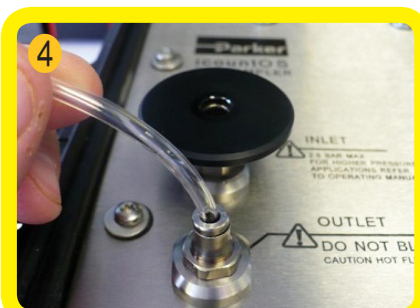
Coloque a mangueira de SAÍDA (Ø 4 mm)
