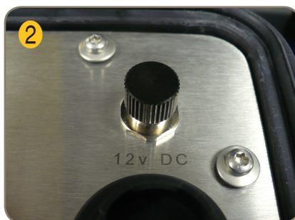
Desparafuse a tampa de proteção e remova
