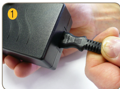
Conecte o cabo à fonte de alimentação
