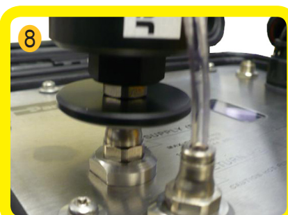
Verifique se o encaixe está nivelado
