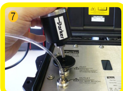
Pressione a VAP firmemente na porta INLET (entrada)
