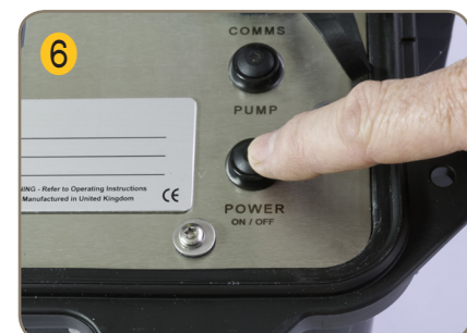
Ligue o icountOS. O botão piscará, indicando 'On charge'.
